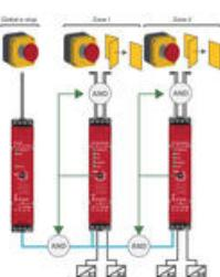
I detta fall övervakar S1 övergripande nödstopp och skickar en säker patenterad enkanalig signal till underliggande säkerhetsreläer som i sin tur övervakar egna zoner. Varje enskild zon kontrolleras av var sitt säkerhetsrelä med dubbla säkerhetsingångar som är konfigurerat i "AND"-logik. Systemet kan också konfigureras med en blandning av "AND", "OR" eller "AND"/"OR".
