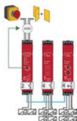
En enkel enkanalig sammankoppling mellan säkerhetsrelä och utgångsexpansion via den patenterade enkanaliga signalen. På detta sätt rör man inte sina säkra utgångar på säkerhetsreläet. Varje utgångsexpansion ger var för sig 4 NO säkra utgångar, direkta eller tidsfördröjda.
